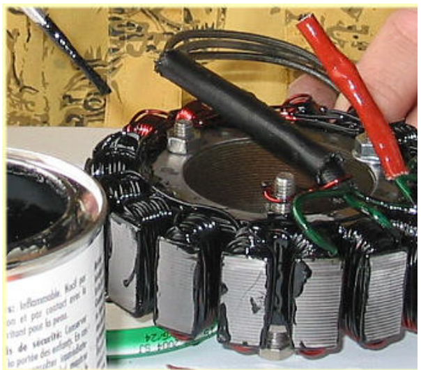
Jetzt wird die ganze Wicklung zum Schutz vor Hitze und Öl mit dem Bremsöl angestrichen. Dazu habe ich drei Schrauben als Abstandshalter eingeklebt.
