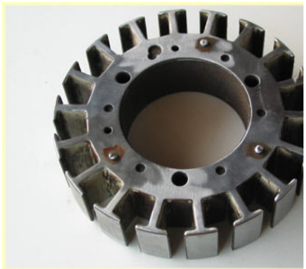
Der Stator komplett abgewickelt und gereinigt (Klarlack entfernt).
