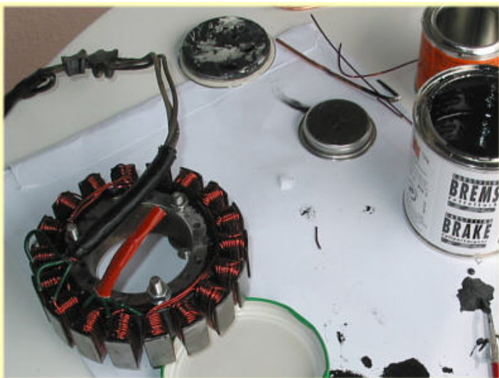
Nochmals auf Durchgang und Kurzschluß kontrollieren.
