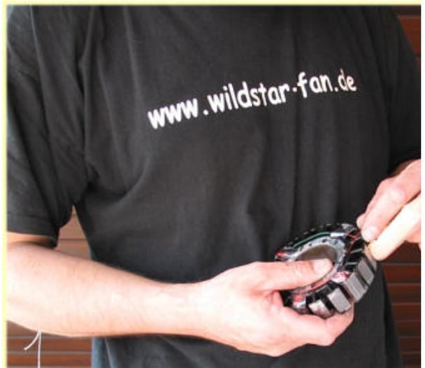
**Der Draht muß beim Wickeln sta angespannt werden damit er auf die paßt.**
