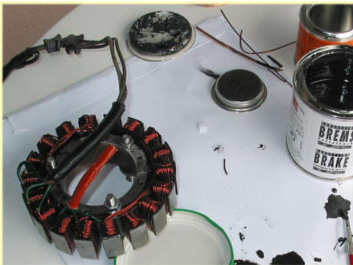
**Die Drähte sind angeschlossen und mit Hitzefestem Schlauch gesichert.**
