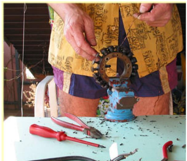
**Wenn die Wicklungen klar stehen, mit dem abwickeln begonnen werden dem abwickeln besorgt man sich bei Betrieb für Elektromotoren den spez Draht. Muster mitnehmen und Länge abschätzen.**
