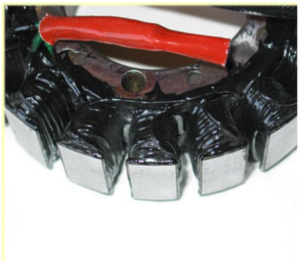
**Wenn der Lack ausgehärtet ist, die außenliegenden Flächen mit der D... sauber abschleifen. Hier dreht sich...**
