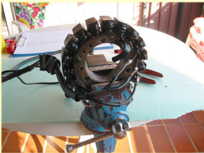
**Zuerst wird der ST in einen Schraubstock eingespannt.**
