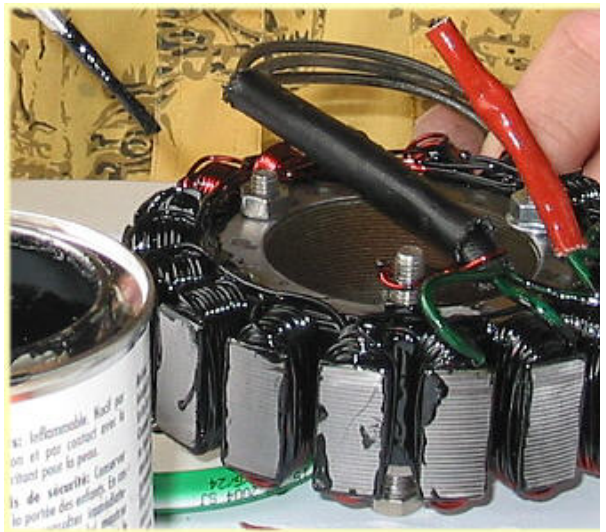
Jetzt wird die ganze Wicklung zum Schutz vor Hitze und Öl mit dem Bremslack angestrichen. Dazu habe ich drei Schrauben als Abstandshalter eingeklebt.
