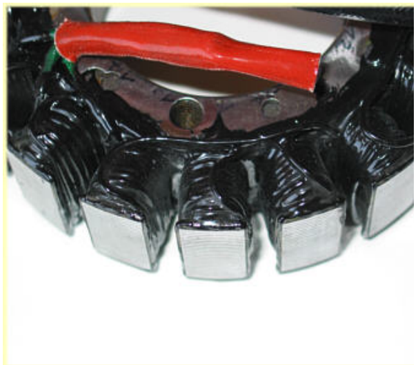
Wenn der Lack ausgehärtet ist, die Außenliegenden Flächen mit der Dremel sauber abschleifen. Hier dreht sich
